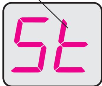
Индикация «Большая нагрузка» означает, что применяемый инструмент используется на скорости либо мощности не предназначенной для него. Либо вы сильно давите. Чтобы устранить Аварийный режим «Большая нагрузка» необходимо:
