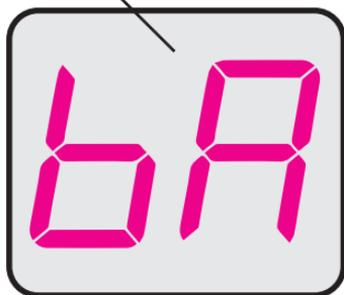
Причиной появления такого сигнала может быть неисправность электронных элементов силового блока.
